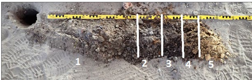
Afbeelding 5. Foto van boring 3, waarbij 1: vergraven grafgrond met puin, 2: E-horizont, 3: B-horizont, 4: B/C-horizont, 5: C-horizont
